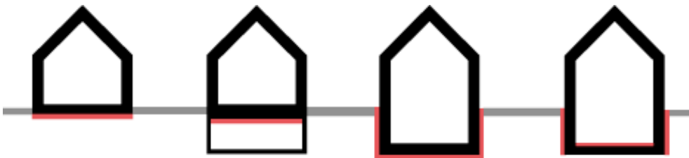
Bild 1: Schematische Darstellung verschiedener Wärmedämmungen von Bauteilen im Erdkontakt.
